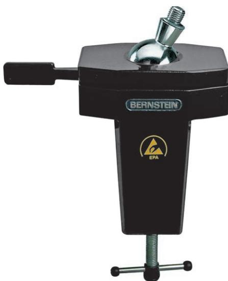
Струбцинное металлическое основание с шарниром и винтом M12x0.5 для рабочих мест с толщиной стола до 80 мм. База предназначена для дальнейшего крепления антистатических тисков, держателей и адаптеров.
