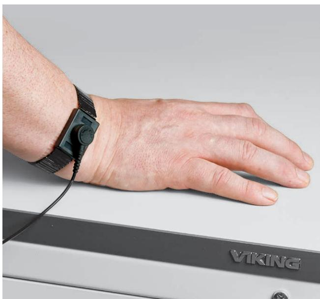
Способ стационарного заземления для работающего монтажника или ремонтника. Стекание заряда происходит через браслет с гарнитурой заземления на общую шину. Браслеты регулируемые, эластичные, с добавлением токопроводящих нитей, гипоаллергенные. Заземляются через узел заземления VKG A-3146 кнопкой «папа» 10 мм.
