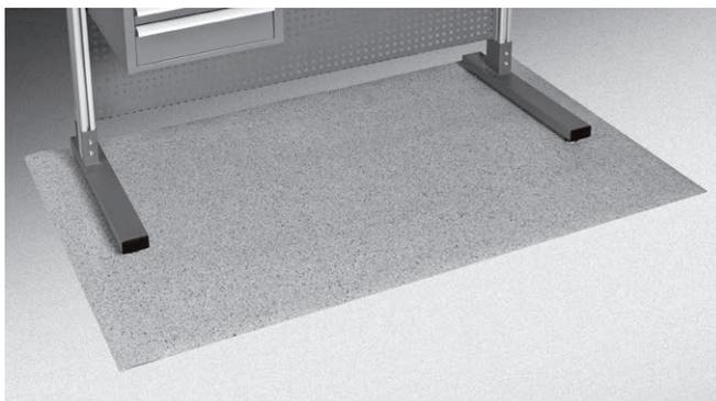
Двухслойный антистатический напольный коврик толщиной 2,5 мм, суперизносостойкий, шумопоглощающий, негорючий, термостойкий, верхний слой рассеивающий, нижний – проводящий: время стекания заряда от 1000В до 50В – менее 0,5 с, сопротивление относительно земли менее 100 МОм, комбинированное сопротивление менее 35 МОм. Размер 120×190 см. Возможно изготовление по индивидуальному размеру.
