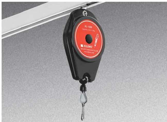
Предназначен для крепления инструментов, которые должны быть всегда под рукой. Подвес имеет подпружиненную катушку с намотанным на нее поддерживающим тросиком. Натяжение тросика регулируется в зависимости от веса инструмента. Крепится к инструментальной планке.
