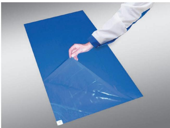
Коврик предназначен для размещения перед входом в зону EPA для очистки антистатической обуви от загрязнений. Состоит из 30 слоев с липким покрытием, последовательно удаляемых при загрязнении поверхности. Каждый слой коврика выполнен из полиэтилена низкой плотности и имеет липкий слой на акриловой основе.
