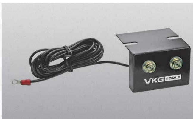
Объединенный узел для подключения гарнитуры заземления ковриков, браслетов и приборов. Имеет две кнопки 10 мм и заземляется через соединительную колодку. Монтируется под столешницей.
