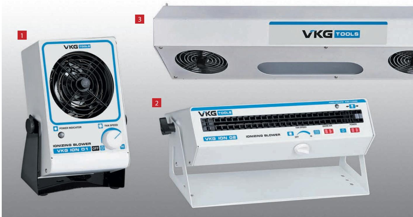
Ионизаторы производят воздушный поток, насыщенный положительно и отрицательно заряженными ионами. Направив этот поток на заряженный объект, можно нейтрализовать заряд статического электричества. Если объект имеет отрицательный или положительный заряд статического электричества, то он притянет заряженные ионы противоположного знака из воздушного потока, которые и нейтрализуют заряд объекта.
