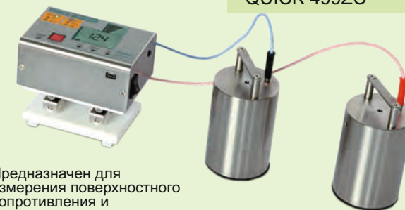
Прибор измерения поверхностного сопротивления QUICK 499ZC
